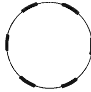
Fig. 7 - Cerchio di sfasamento con modulazione di intensità. Il rapporto 6 è indicato dai tratti più scuri.
