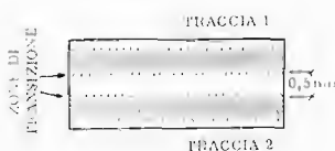
Fig. 15 - Ad evitare interazioni tra le due tracce del nastro magnetico, si lascia, ai lati di ogni traccia, una zona inutilizzata, detta di « transizione ».
