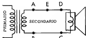
Fig. 6 - Per verificare la continuità del secondario del trasformatore di uscita, e della bobina mobile, occorre interrompere il circuito nel punto E, e misurare, rispettivamente, tra A e B e tra C e D.
