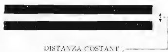
Fig. 4-B - Se invece i bordi delle connessioni stampate sono regolari, con distanza costante, il pericolo di scarica diventa trascurabile.
