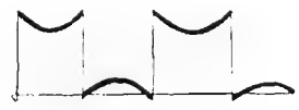
Fig. 15 - Forma d'onda di un segnale ad onda quadra, alterata in seguito al passaggio in un circuito con responso scarso alle frequenze basse.
