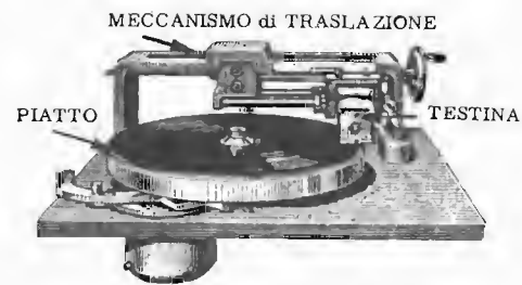
Fig. 3 - Tipo di macchina per registrazione su disco. Sono visibili il motore (inferiormente), il piatto pesante, la testina ed il meccanismo di trascinamento di quest'ultima.
