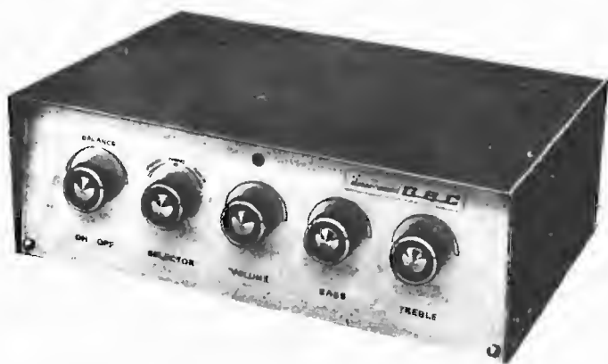
Fig. 1 - Aspetto dell'amplificatore stereofonico interamente montato. È visibile la posizione dei diversi comandi installati sul pannello frontale. L'intero apparecchio è racchiuso in una elegante cassetta metallica, verniciata a fuoco. Sulla superficie superiore sono visibili le feritoie praticate nella lamiera, per favorire la circolazione dell'aria, necessaria per evitare il surriscaldamento all'interno.
