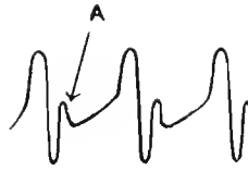
Fig. 13 - Segnale ottenuto col circuito di figura 11, ma con resistenza di griglia di valore molto alto. Ogni impulso è di due cicli, e si smorza nel punto A, per riprendere dopo un certo intervallo.
