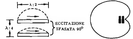
Fig. 2-B - Se si riduce la distanza a \lambda : 4 , e lo sfasamento a 90^\circ , il diagramma di irradiazione diventa monodirezionale, come illustrato a lato.
