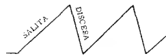
Fig. 4 - Tensione a dente di sega. Il tratto in discesa è più rapido di quello in salita. L'esplorazione dello schermo ha luogo col tratto in salita.
