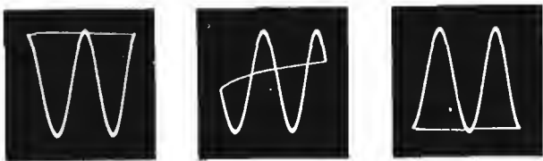
Fig. 4 - Spostamenti di fase dell'immagine riprodotta sullo schermo fluorescente del tubo a raggi catodici, agendo lentamente sul verniero per la regolazione della frequenza della tensione a dente di sega, dopo aver fermato l'immagine mediante un adeguato segnale di sincronismo.
