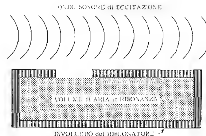
Fig. 10 - Esempio di risonatore di Helmholtz. Se le onde sonore che passano in prossimità dell'apertura hanno una frequenza pari a quella di risonanza della massa d'aria contenuta nell'involucro, questo risona con un conseguente effetto di amplificazione.
