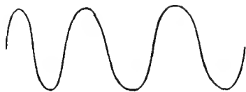
Fig. 15A - Forma d'onda del segnale ottenuto col circuito di figura 14, dando alla resistenza R un valore di 2.500 ohm. Come si nota, l'andamento è abbastanza regolare
